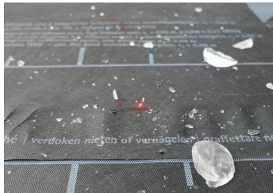
Die pro clima-Unterdachbahnen bleiben auch nach mehrfachem Beschuss mit den grösstmöglichen Hagelkörnern unbeschädigt
