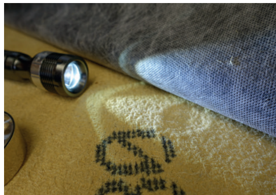
Die darunterliegende Holzfaserplatte hat nach Beschuss mit 50 mm Hagelkörnern eine ca. 4 mm tiefe Delle
