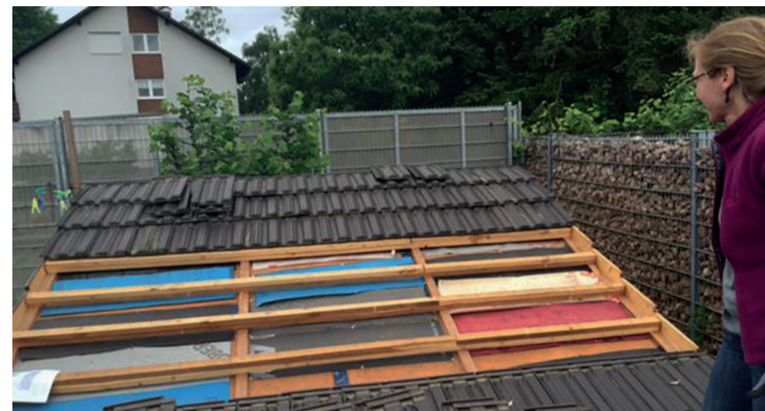
Untersuchung von frei gespannten Unterdachbahnen verschiedener Hersteller 5 Jahre nach dem Einbau
