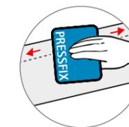
Liner komplett lösen und dann mit ca. 2-5 cm Überlappung verkleben. Mit Pressfix gut anreiben.
