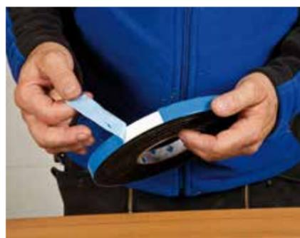
Äußere Schutzfolie mit dem Cuttermesser auftrennen und abziehen.
