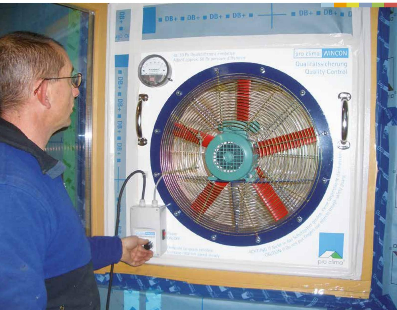
Die schnelle und einfache Prüfung der Luftdichtungsebene
