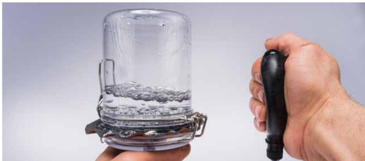
Dieser einfache Test zeigt die alte Technologie. Die Bahn hat Mikroporen (kleine Löcher), durch die Luft strömt. Bei herabgesetzter Oberflächenspannung von Wassertropfen kann sie auch undicht gegen Wasser von außen werden
